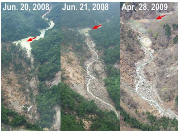
写真-1 「河道閉塞による湛水を発生原因とする土石流」の事例
