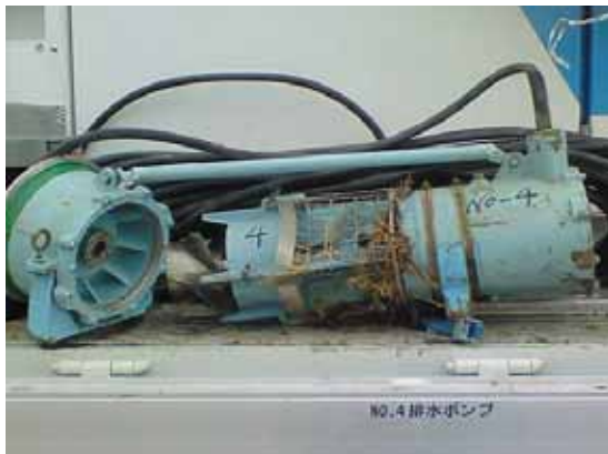
図-14 破損した排水ポンプ
