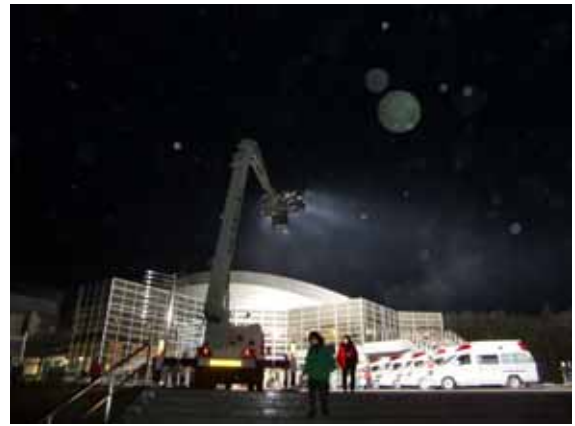
図-20 避難所での夜間照明として照明車の活用（宮城県南三陸町 べいっぴーアリーナ）
