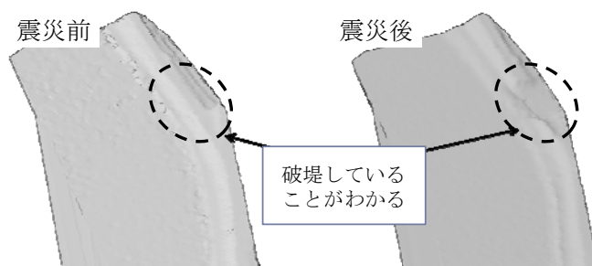
【凡例】 --- 震災前 — 震災後 図-16 震災前後3次元CADデータ任意断面Iの可視化
