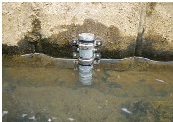
投込式水位計(ロガー式)
