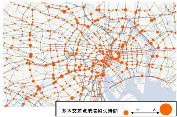
図-7 交差点単位の損失時間の分析事例
