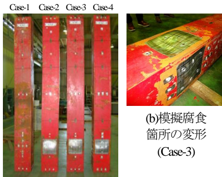
図-11 荷重除荷後の試験体の破壊状態
