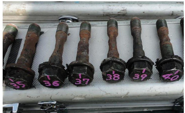
写真-5 セットボルトの断面欠損状況(1)
