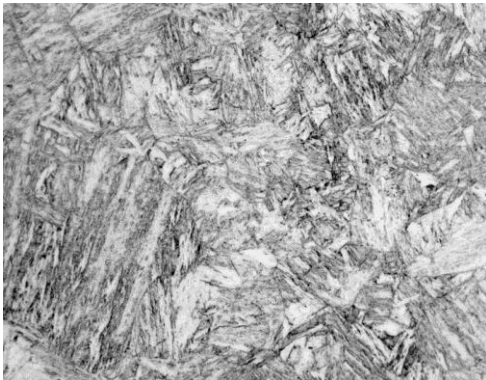
写真-13 断面マイクロ組織（ベイジク組織）
