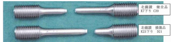
写真-9 \phi 8\text{mm} 試験片ボルトの破断状況
