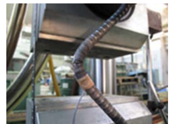
写真-1 試験状況 (折り曲げ鉄筋)
