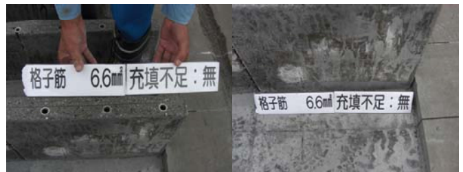
写真—8 断面積 6.6mm 2 格子筋の放熱管周囲の充填性状況
