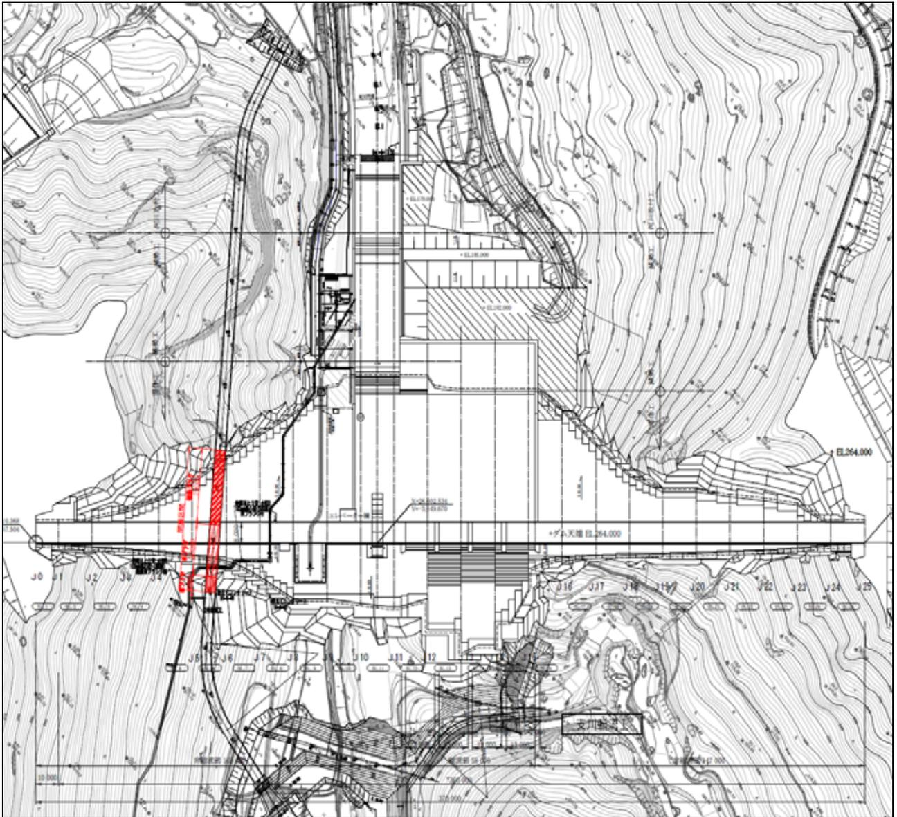
図-1 大山ダムの堤外仮排水路プラグ区間平面図
