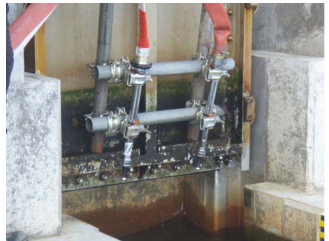
図-5. 消防用ノズルを用いた試作装置
