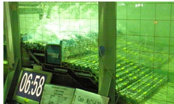
写真-4 越波流量の水理模型実験状況
