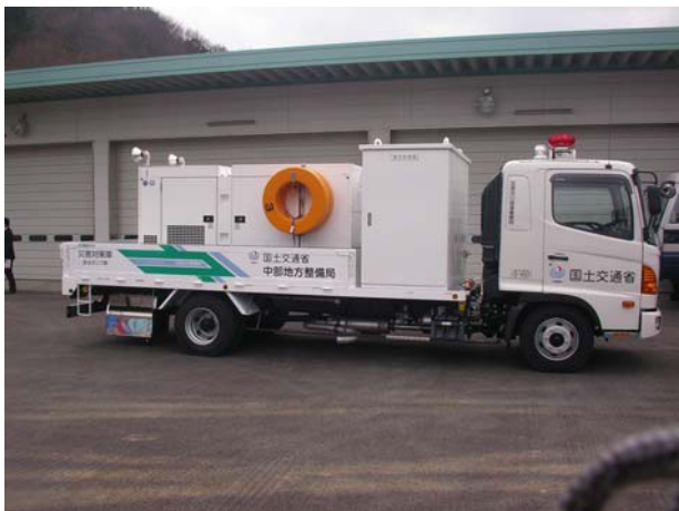
写真-2 排水ポンプ車外観
