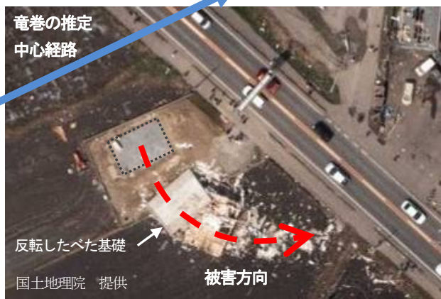
図-14 基礎を伴う上部構造が転倒した木造建築物の被害状況
