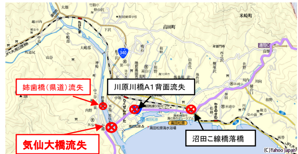
図-1 陸前高田市内の国道45号被災状況
