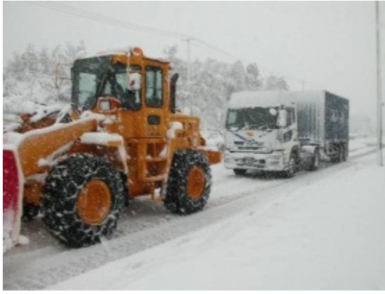
写真-4 除雪ドーザーによるスタック車両牽引状況
