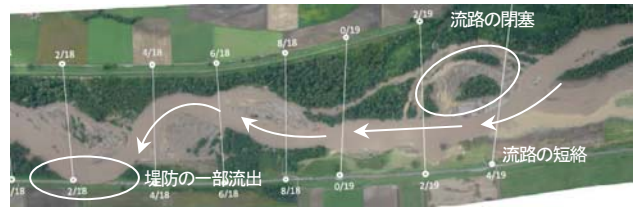
写真-7-2 出水中の状況 (KP19.2~19.6、H23年9月7日 AM12 時頃撮影)
