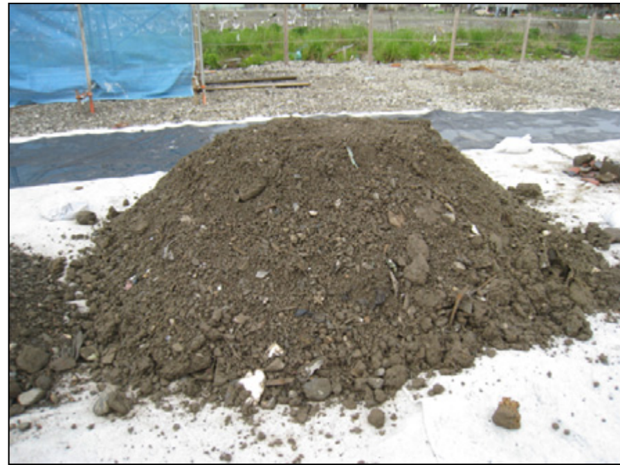
分級礫(スクリーン処理、20~100mm) がれき・ごみが若干混入
