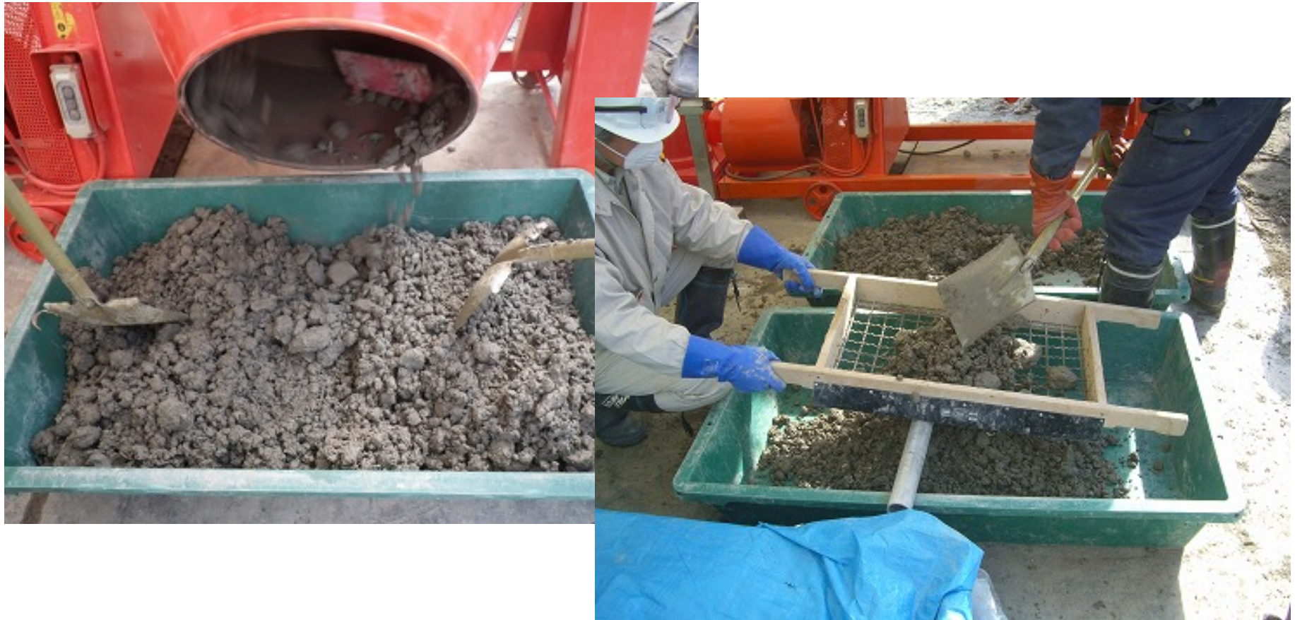
練混ぜおよび40mmのウェットスクリーニング状況
