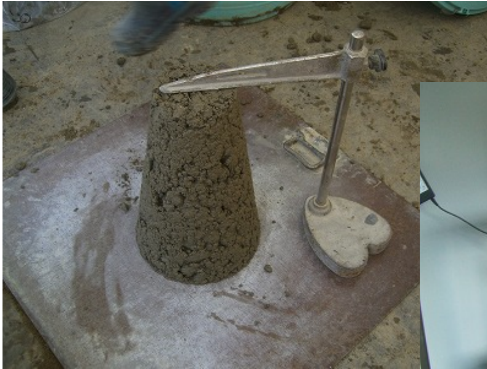
スランプ試験状況
