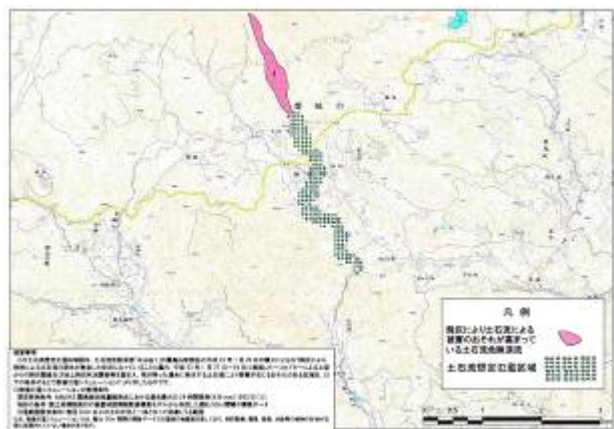
図-1 2011年1月27日の噴火後の降灰調査結果（上）、降灰域と緊急調査の対象となった溪流分布（中）、重大な土砂災害の想定区域（下）（2011年2月9日九州地方整備局河川計画課記者発表資料より抜粋）
