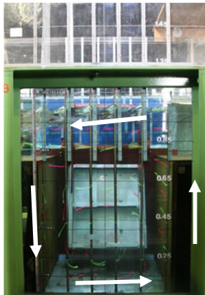
写真-3 タフトを用いた排水溝内の流況
