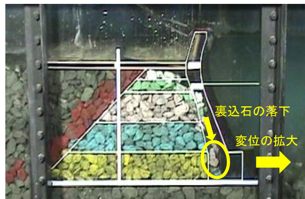
写真-1 変位拡大の引き金となる裏込石落下
