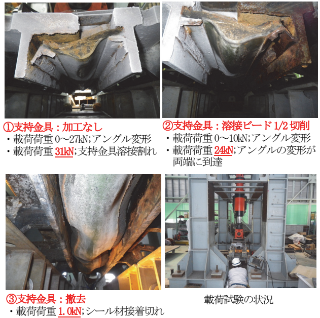
写真-2 既設橋の切り出し部材による荷重試験
