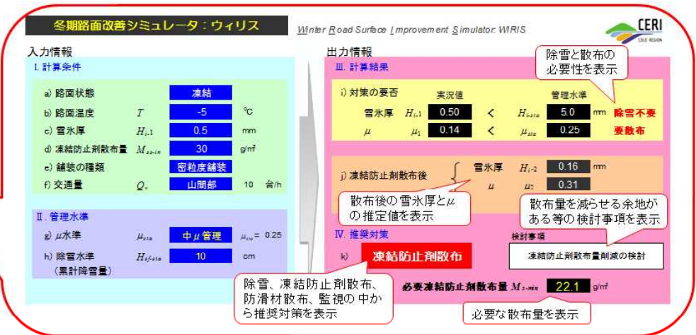
図-4 冬期路面改善シミュレータ WIRIS
