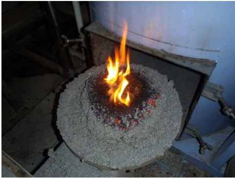
図-10 クリンカーの発生状況
