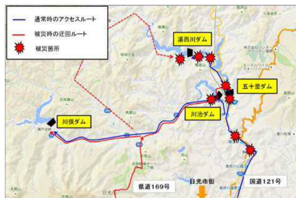
図-4 ダム周辺の道路被災状況
