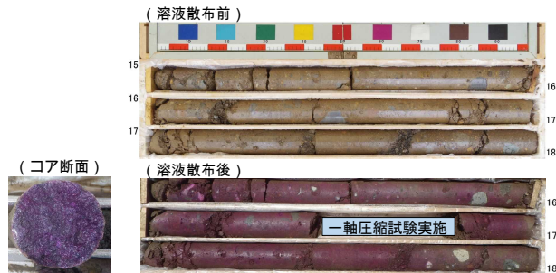
図-2 フェノールフタレイン試験結果の一例 (深度15~18m)
