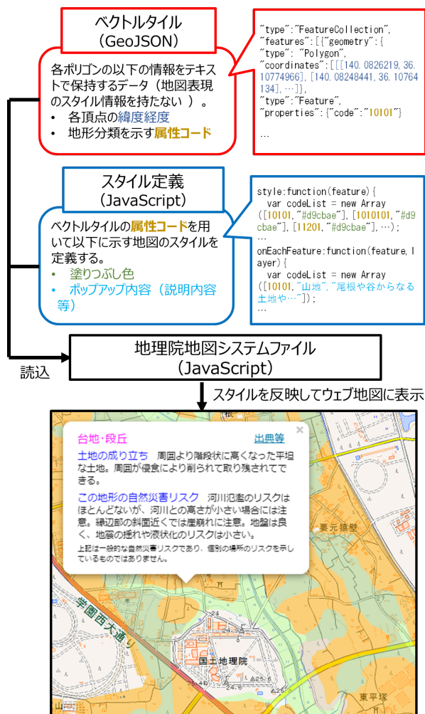
図4 ベクトルタイルをウェブ地図で表現する仕組み
