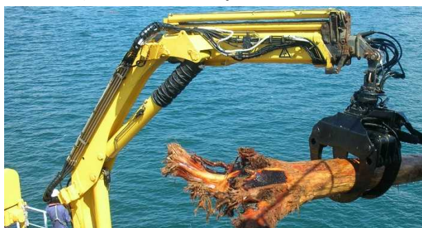
写真-7 油圧ホース応急復旧後(白ホース部分)
