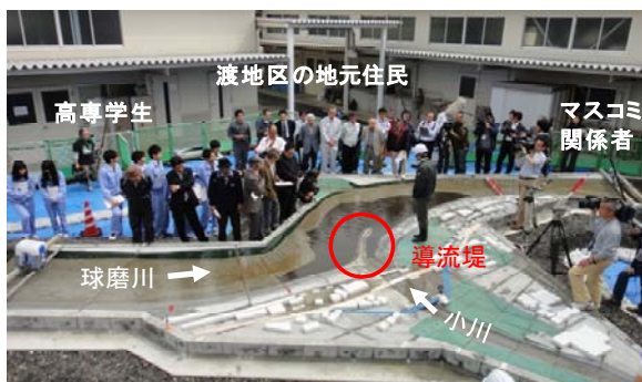
写真-2 小型模型による公開模型実験の様子
