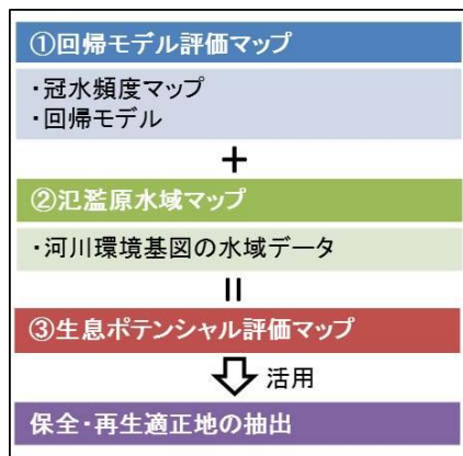
図-2 河道内氾濫原の評価フロー
