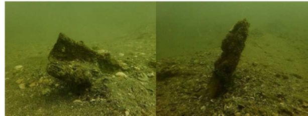
写真-4 潜水探査(確認)時の水中写真 (鋼矢板(左)、鉄パイプ(右))
