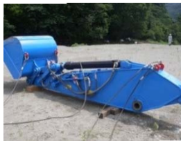
アーム仮置状況
