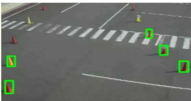
写真-15 工事規制を検出する技術
