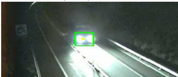
写真-13 ハレーションによる車両検出
