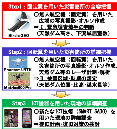
図-2 ICT技術を活用した初動対応の実証実験（奈良県五條市赤谷地区）
