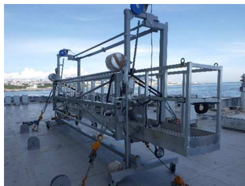
写真-5 製作した明石塔作業車(東西面用)
