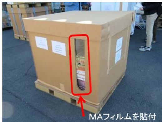
写真-1 試作した鮮度保持ボックス
