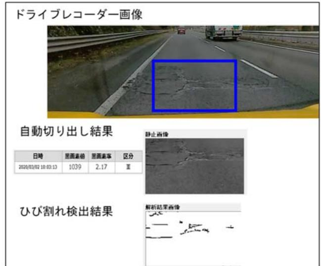
図-12 ひび割れ解析の仕組み
