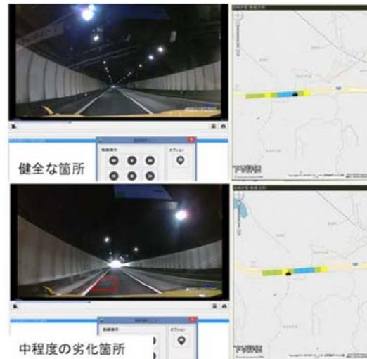
図-10 トンネル内評価の例
