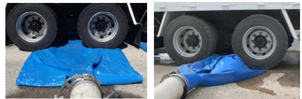
写真-13 走行速度の違いによる試作ホース状況 (左：5.0km/h程度、右：10.0km/h程度)
