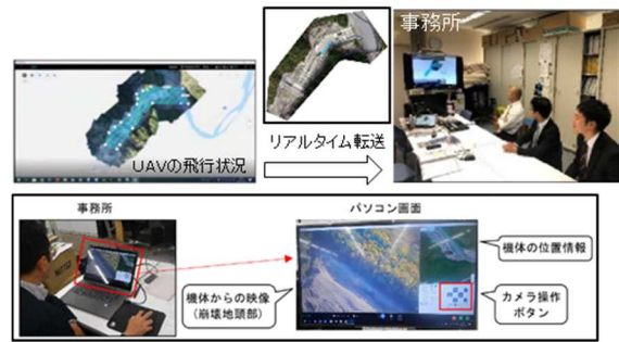
図-7 UAVと遠隔地間での映像共有
