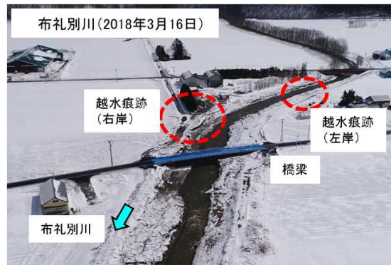
写真-2 アイスジャムによる越水痕跡（布礼別川）
