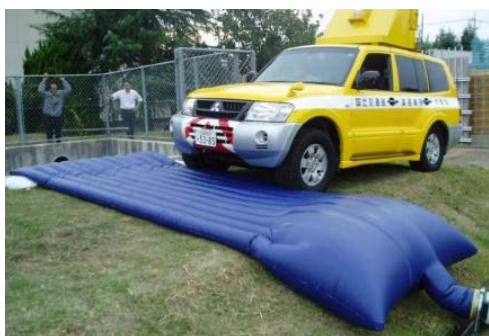
写真-3 過年度の試作ホース（10水路）の外観
