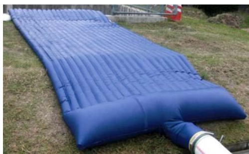
写真-4 過年度の試作ホース（20水路）の外観
