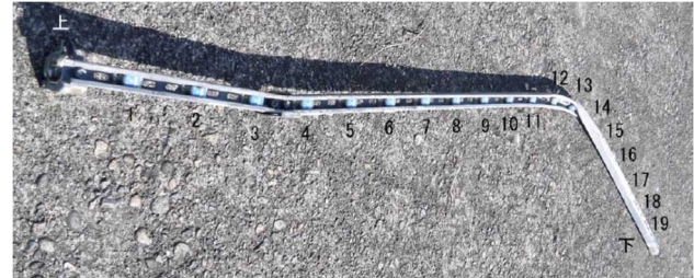
図-11 2020 年 7 月洪水後に引き上げた水温計の例
