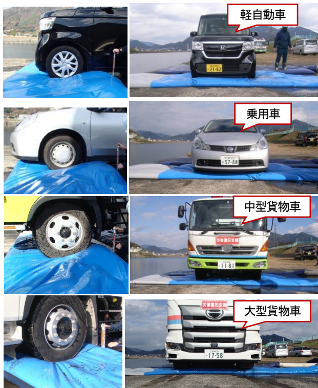
写真-11 試作ホースの車両横断状況
