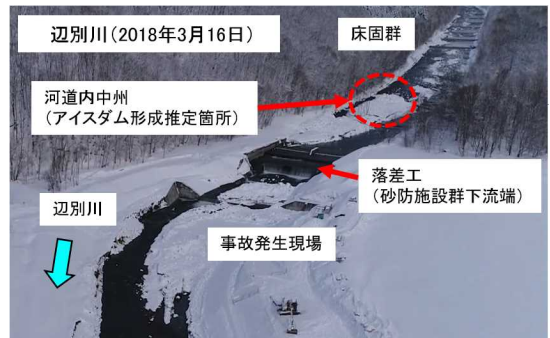
写真-3 アイスジャム再流下による被災（辺別川）
