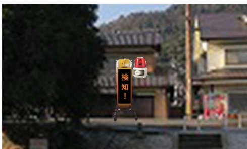
図5-3 警告発報機器類現地設置イメージ
