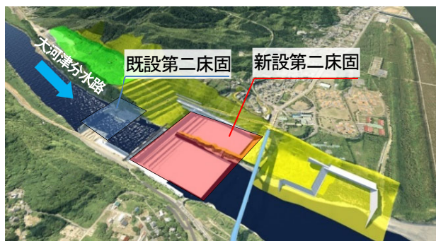
図-5 第二床固 (既設・新設)
