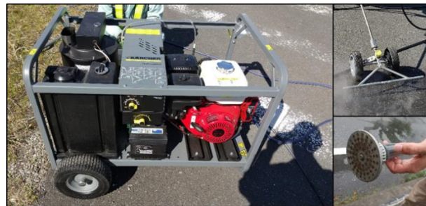
温水高圧洗浄機 アタッチメント 図-6 温水除草システム
