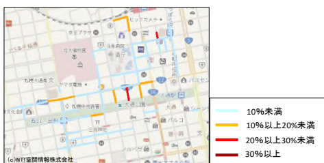
図-3 加速度データを活用したモニタリング例 箇所別急制動発生確率
