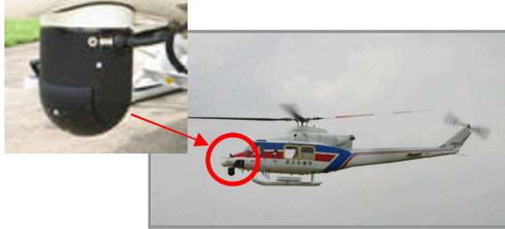
図6 赤外線熱画像用カメラを搭載した「ほくりく号」
