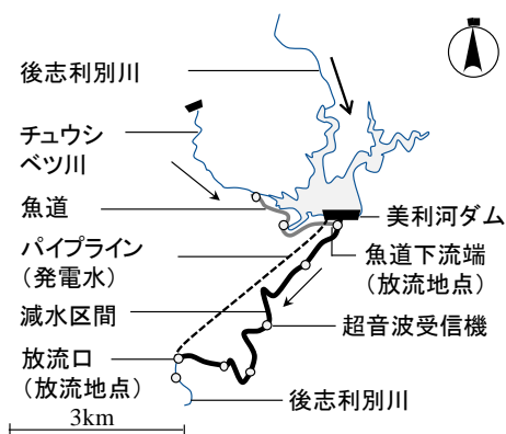
図-1 調査範囲および超音波受信機設置状況
