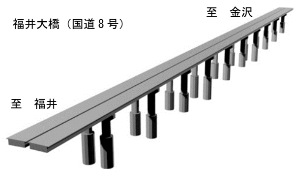
図-12 LOD200で3次元モデリングした橋梁
