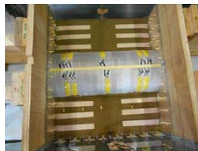
写真-8 帯状補強材の配置状況
