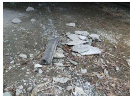
写真-4 落下したコンクリート片
