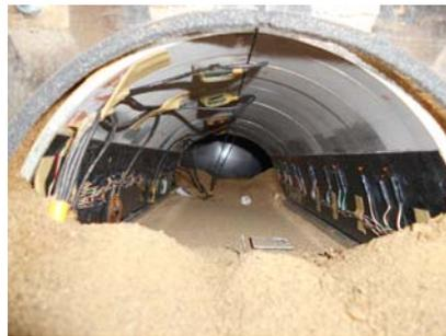
写真-12 CASE-2加振後の内部状況
