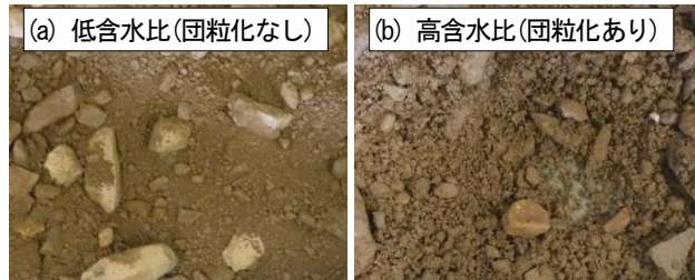
写真-3 含水状態による団粒化の影響（同一粒度）
