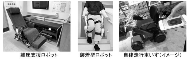
図-3 実用化されている介護用ロボットの例
