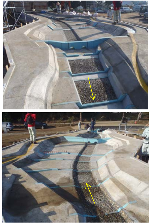
写真-5 大暗渠形式 模型全景
