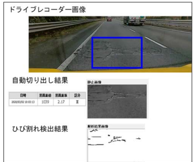
図-12 ひび割れ解析の仕組み
