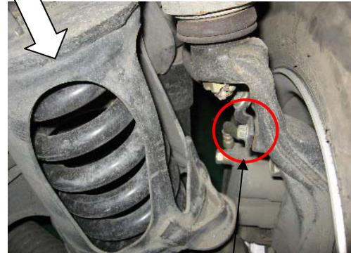
ブレーキホースを固定するブラケットのボルトの締付けトルクが不十分なものがある。そのため、ボルトが緩みブレーキホースブラケットが脱落し、ブレーキホースが損傷しブレーキ液が漏れて制動力が低下するおそれがある。
