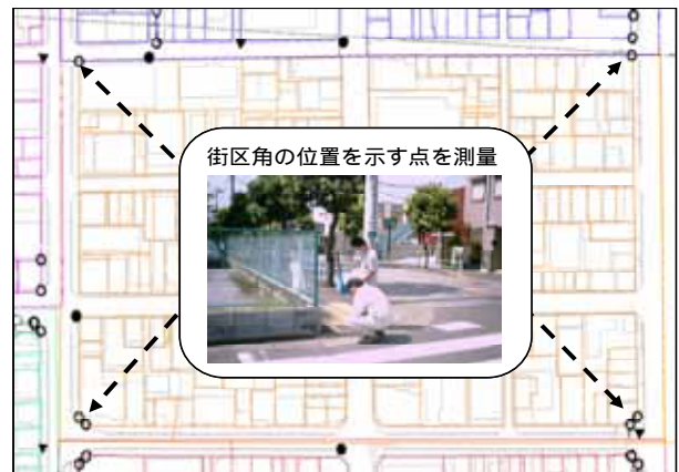
( 図 3 ) 街区点の調査
