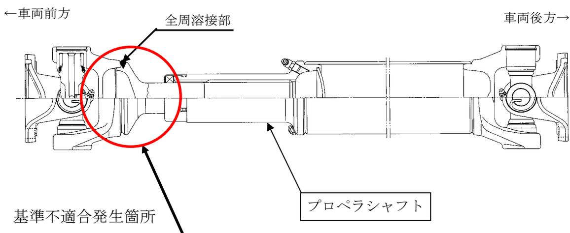
プロペラシャフトのヨーク部の溶接強度が不足しているものがある。そのまま使用を続けると、当該溶接部に亀裂が生じ、最悪の場合、プロペラシャフトが破断し、走行不能となるおそれがある。
