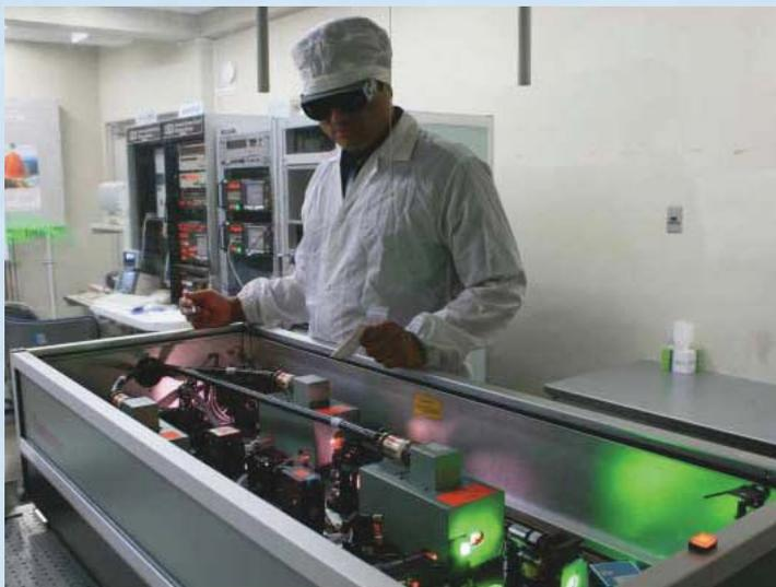
人工衛星レーザー測距装置を点検する海上保安官
