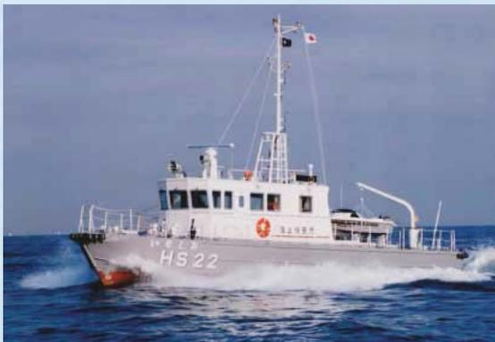
測量船いそしお（総トン数32t、長さ21m、幅4.5m、最高速力約15ノット（時速約28km））
