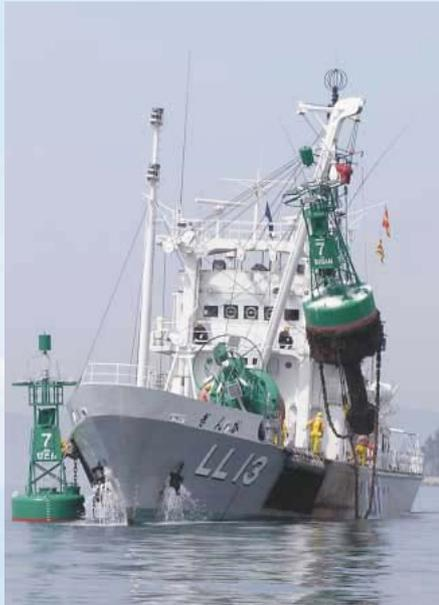
と気合も十分に各自ヘルメットの顎紐を締め直す。現場は「海の銀座」備讃瀬戸東航路の出入口で、高速道路のインターに匹敵する海域だ。作業に従事する船舶は、全国で2隻となった設標船のうちの1隻である第六管区海上保安本部所属の設標船「ぎんが」（約600t昭和55年3月建造荷役性能15tのクレーン装備）で、灯浮標（ブイ）の交換業務を主任務として船舶交通の安全を支えている。
