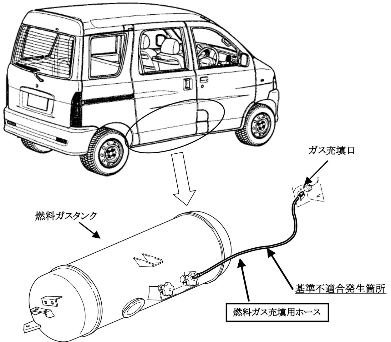
〔 液化石油ガス(LPG)車において、燃料ガス充填用ホースの材質が不適切なため、使用過程において当該ホースの表面に亀裂が発生するものがある。そのため、そのまま使用を続けると、亀裂が進行し、燃料ガス充填時にガスが漏れるおそれがある。 〕
