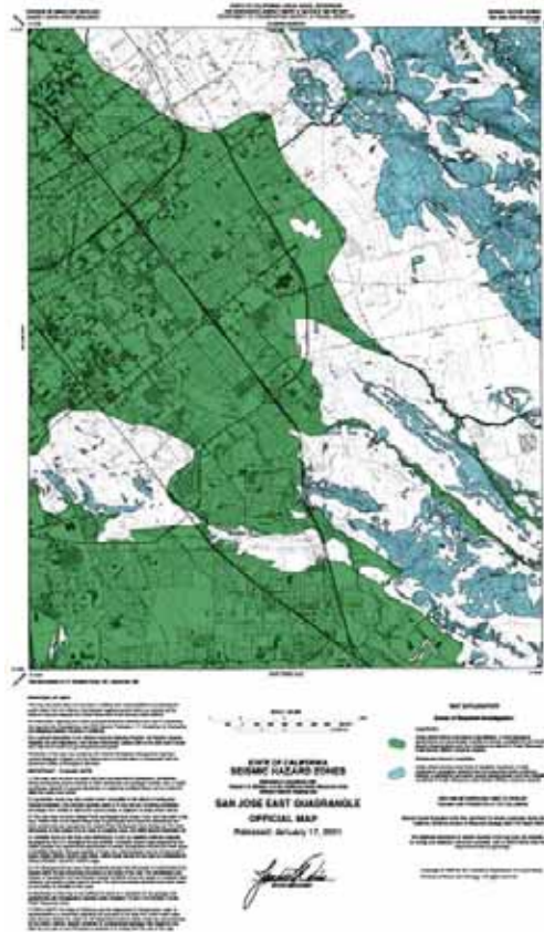
図 3.2 カリフォルニア州地震災害ゾーン地図の例 1/24,000 San Jose East 州鉱山地質局(2001)による。 開発に際して調査が必要となるゾーン(緑色, 水色)を示す。 緑色は液状化, 水色は地震による土砂災害の実績または可能性がある。 村山(2007)
