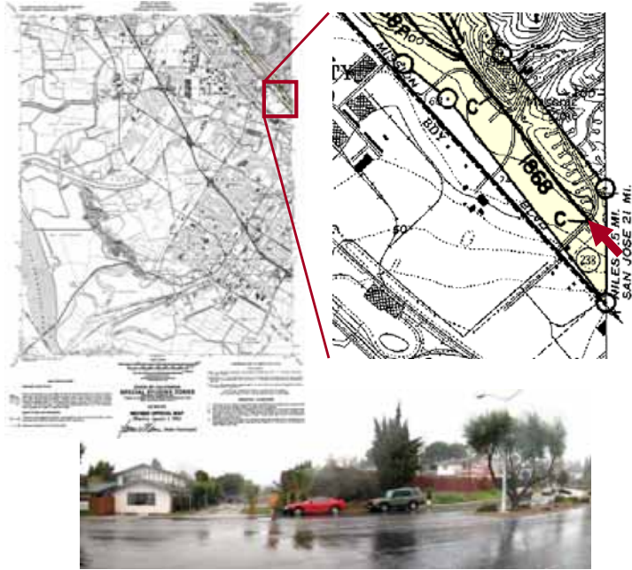
図 3.1 カリフォルニア州活断層法による土地利用規制の例 左上:活断層図 1/24,000 Newark 州鉱山地質局(1982)による。 図の右上を斜めに横切る帯状のクリーム色の範囲が「特別調査ゾーン」。 右上:その拡大図, 矢印は写真撮影位置と方向を示す。 下:中央部を Hayward 断層が通り, その周囲は緑地になっている。 2002年2月 筆者撮影。 村山(2007)
